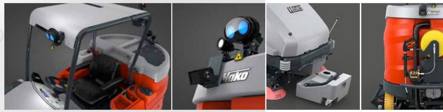
Die neue Scrubmaster B400-R-Linie ermöglicht lange unterbrechungsfreie Arbeitseinsätze: mit einer hohen Flächenleistung von bis zu 14.000 m²/h durch den großen 400-Liter-Frisch- und Schmutzwassertank sowie einer maximierten Batteriekapazität durch das optionale Batteriewechselsystem. Mit 3-Tellerbürsten-Deck, zwei Arbeitsbreiten von 123 cm und 155 cm und vielen serienmäßigen Extras ist die neue Linie bereit für größte Aufgaben.
